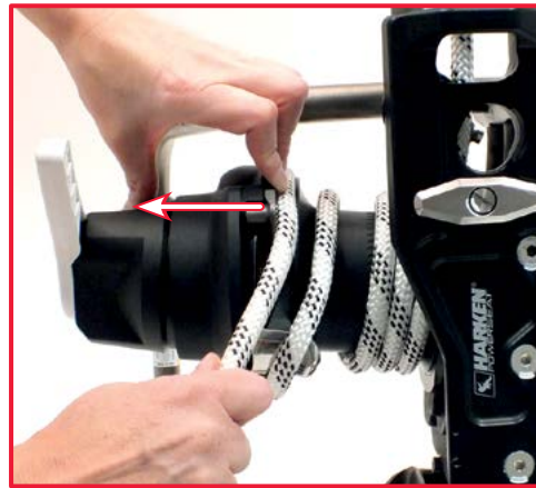
10. Das Seil zwischen die beiden Halbrollen durchführen. Um die Arbeit zu erleichtern, den Deckel anheben
