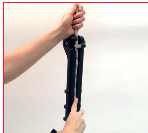
4. Das Seil im frontalen Rohr positionieren
