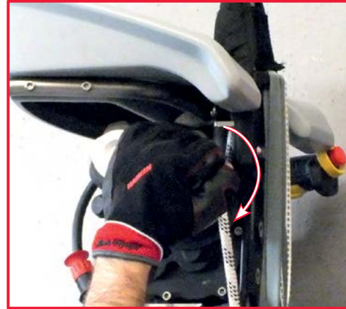
2. Mit der anderen Hand den Kontrollhebel im Uhrzeigersinn drehen, damit das Seil auf der Winde-Glocke rutschen kann und der kontrollierte Abstieg des Bedieners erfolgt. Um die Abstiegs-geschwindigkeit zu regeln, die Loslass-geschwindigkeit des Seils am Ausgang der Winde von Hand kontrollieren. Um den Abstieg zu stoppen, den Kontrollhebel loslassen.
