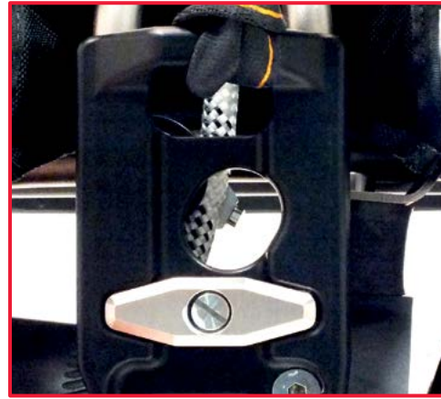
6. Prüfen, dass das Seil korrekt in seiner Aufnahme liegt
