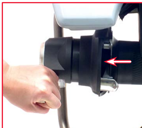
Die Funktionstüchtigkeit des Kontrollhebels der Halbrollen prüfen, indem man ihn dreht und wieder los lässt (HALBROLLE OFFEN).
