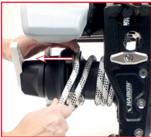
9. Das Seil zwischen die beiden Halbrollen durchführen. Um die Arbeit zu erleichtern, den Deckel anheben
