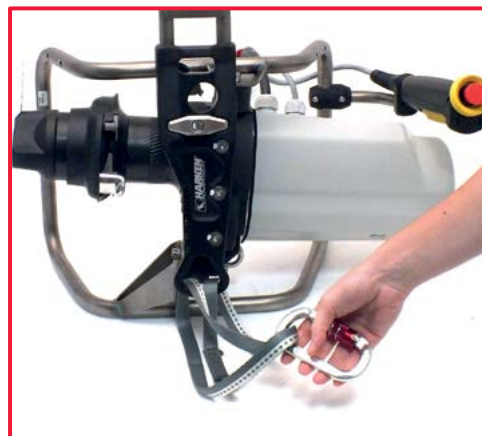
6. Die Schlaufe am unteren Verankerungspunkt befestigen
