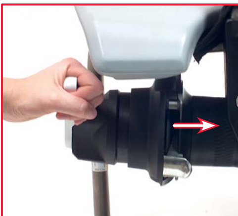
Die Funktionstüchtigkeit des Kontrollhebels der Halbrollen prüfen, indem man ihn dreht und wieder los lässt (HALBROLLE GESCHLOSSEN).
