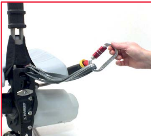
Die Integrität der Schlaufe und des Karabinerhakens kontrollieren.
