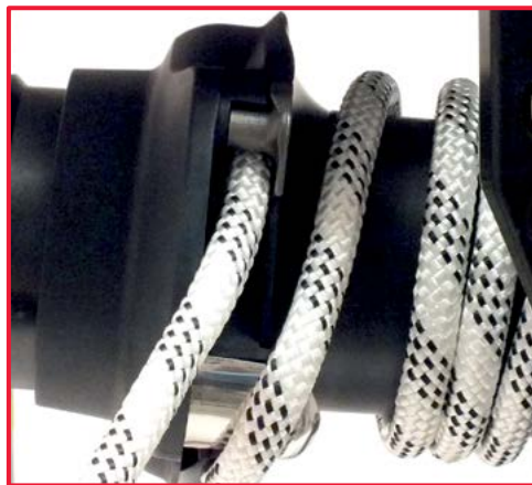
10. Das Seil in der Halterung positionieren
