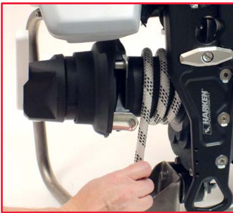
7. Das Seil im Uhrzeigersinn um die Winde-Glocke wickeln
