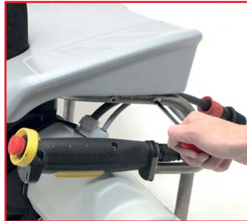
2. Die 4 Befestigungsschrauben des Sitzes am Rahmen mit einem Inbusschlüssel Nr. 5 lösen
