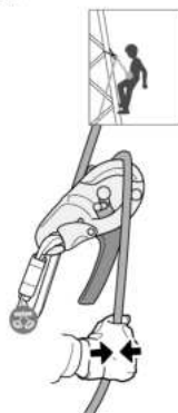
10a. Always hold the brake-side rope when the climber is moving. Tenez toujours la corde côté freinage lors des déplacements du grimpeur
