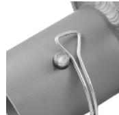
Abb. 3 Nicht ordnungsgemäß gesicherter Beinkupplungsstift
