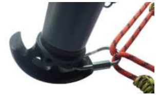
Abb. 13 Seilhoppelbefestigung mittels Schnellverbindungsglied
