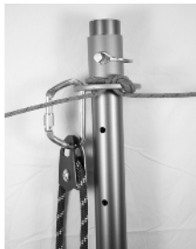
Abb. 25 Verzurr-Ring auf Rüstbaum (Gin Pole) als Hauptbefestigung
